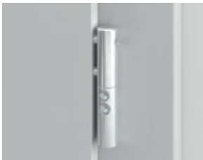
Zawiasy czopowe Ø16, regulowane 3D, wkręcane, w kolorze cynk biały, montowane w drzwiach PPOŻ. SILENZIO HAL 32, SILENZIO HAL 32 i SILENZIO 46/43/42 w standardzie
